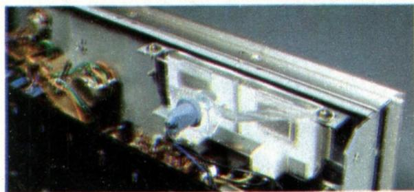
Il dispositivo d'illuminazione dei VU-meter usa una sola lampadina, la cui luce si nota anche attraverso le fessure dell'apparecchio. Sul retro c'è un comodo cambiataensione a slitta.
